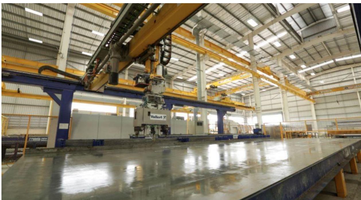
Рисунок 3. Автоматизированный комплекс фирмы Vollert для чистки и смазки универсального формовочного поддона [7]
